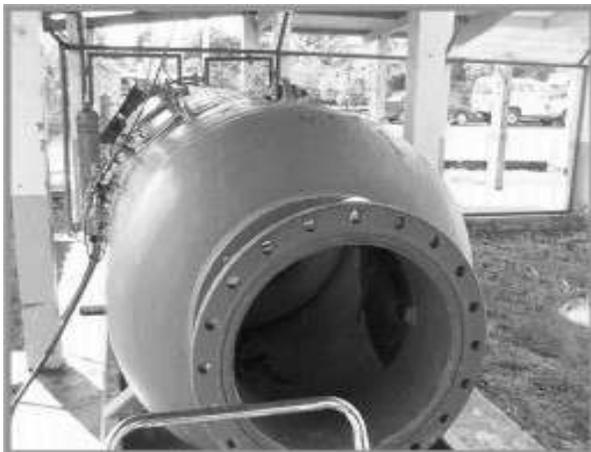
Cámara de Descompresión ubicada en el pasillo del Hospital Nuevo Amanecer de Bilwi, Puerto Cabezas, RAAN desde 1996. Construida a base de acero y hierro, con doble cierre. Una máquina de Perry Submarine fabricada en Riviera Beach, California (EEUU) en 1985.
